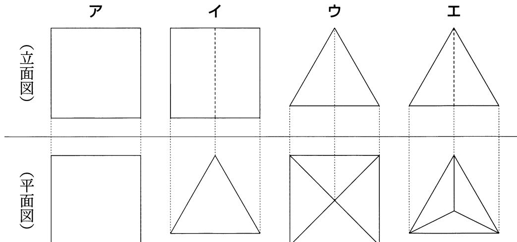
※上の投影図では、実際に見える辺を実線 —— で、見えない辺を破線 ----- で示している。
