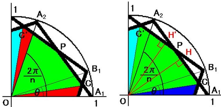
$A_1A_2$ と $B_1B_2$ の交点を $P$ 、 $A_2A_3$ と $B_1B_2$ の交点を $C'$ 、 $O$ から $A_1A_2$ 、 $B_1B_n$ に下ろした垂線の足をそれぞれ $H$ 、 $H'$ とすると、 $\theta$ だけ回転しているの、 $\angle HOH' = \theta$ である。
