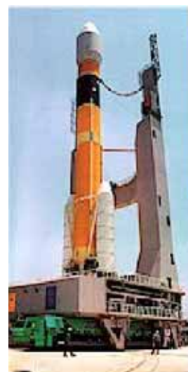
図12 ロケット移動 発射台運搬台車
